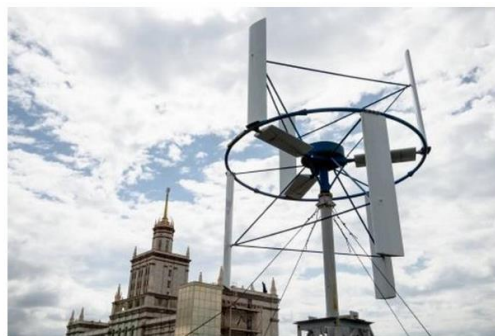
2 сурет. 3 кВт қуаттылығындағы жел энергетикалық қондырғы
